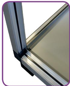
Le caisson est basé sur une **structure** profilée aluminium 55 mm à **rupture de pont thermique** (Classe TB1) associé à des parois double peau isolées par 45 mm de mousse de polyuréthane condensée (Classe T1). La face extérieure reçoit une finition laquée blanc RAL 9002 tandis que l'intérieure reste en acier galvanisé. Le principe d'assemblage de la structure permet une grande rigidité de l'enveloppe et lui procure une classe de déformation exceptionnelle (Classement D1).
