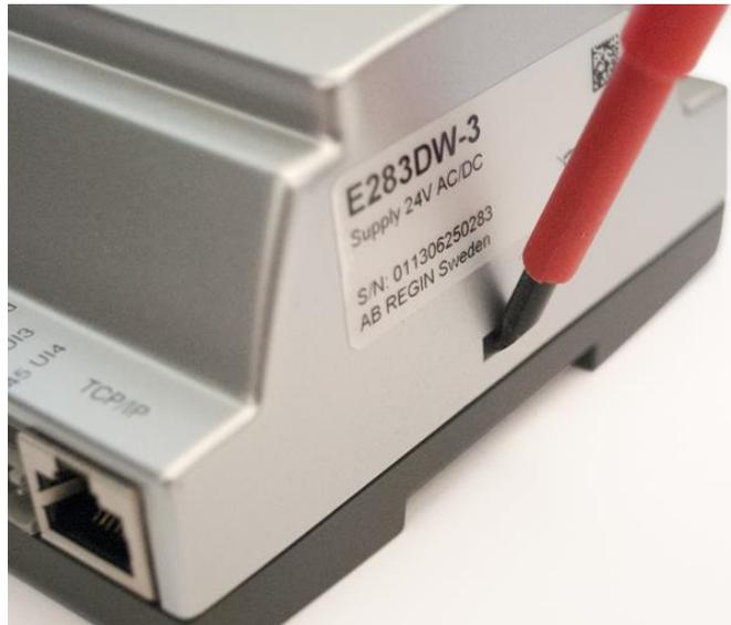
Appuyez sur les clips de chaque côté du boîtier avec un petit tournevis pour désolidariser le couvercle du socle. Maintenez le socle et retirer le couvercle.
