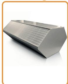
Les échangeurs équipant les centrales Campus sont des échangeurs à plaque aluminium à contre courant parfaitement étanches garantissant 2 flux totalement séparés. Ils permettent d'offrir une efficacité très élevée, jusqu'à 92%. Les caractéristiques et les performances de l'échangeur sont validées par une certification **Eurovent N°11.07.006**.
